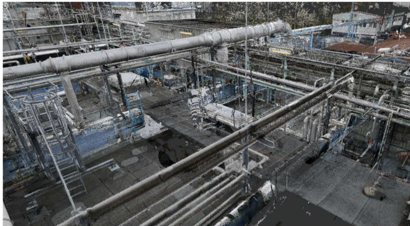
Ergebnis Laserscan (hier: RCS-Punkwolke)
