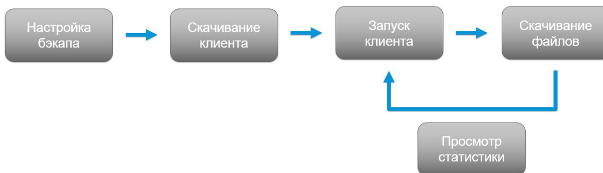
Схема настройки резервного копирования
