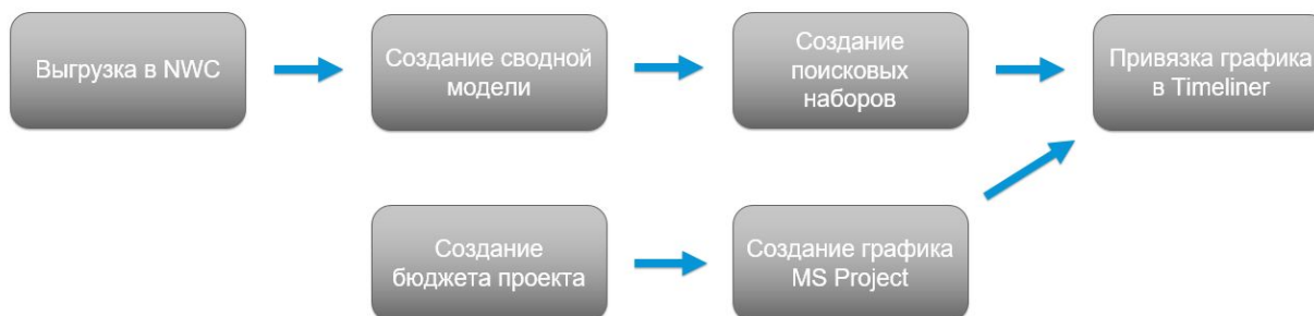
Схема разработки 5D модели
