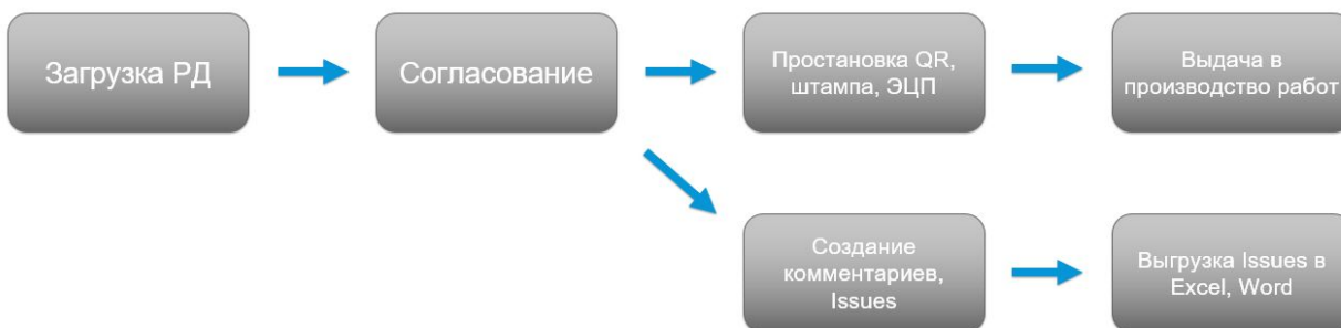
Схема выдачи РД в Производство работ
