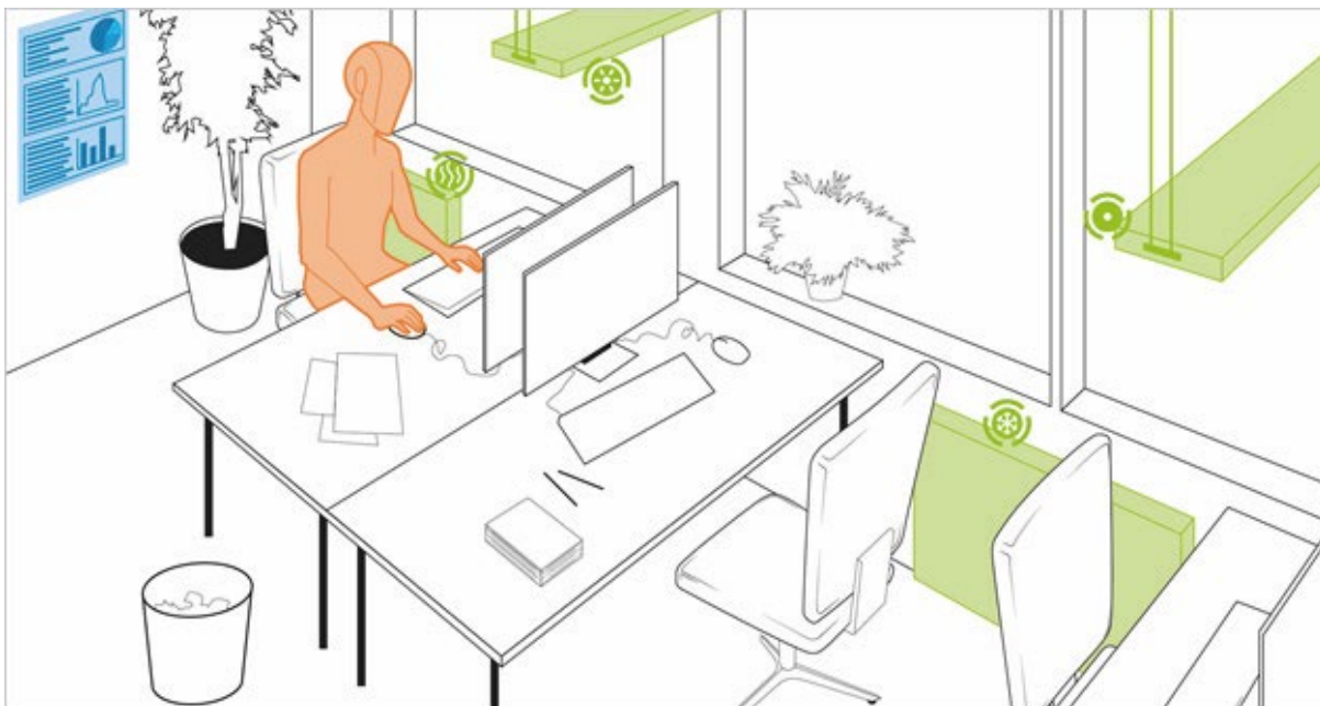
Smartes Energiecontrolling am Büroarbeitsplatz mit angepasster Heizungs- und Beleuchtungssteuerung und Anzeige von gegenwärtigen Energieverbräuchen Legende: blau – digital bereitgestellte Informationen, grün – Ergebnis digitaler Prozesse, rot – realweltlicher Auslöser
